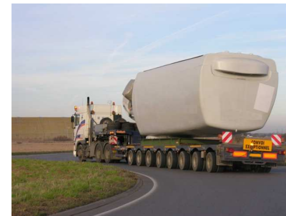
Transport de la nacelle
